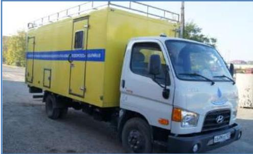
Автотракторный парк РЭУ «Ейский групповой водопровод» ГУП КК «Кубаньводкомплекс» пополнился новым автомобилем «Хюндай». Автомобиль предназначен для бригады аварийно-восстановительного ремонта. Салон автомобиля разделен на две части. В одной установлено шесть сидений для рабочих, в другой – мини-мастерская с верстаком и тисками. В ближайшее время автомобиль будет оснащен необходимым для выполнения аварийных работ оборудованием.
