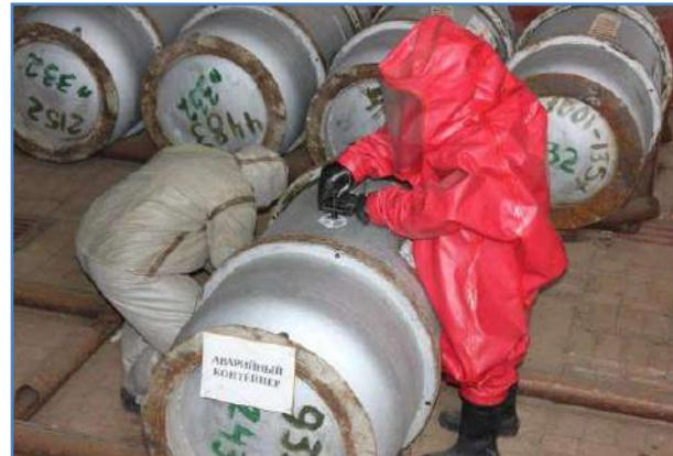
специалистами стояла задача в максимально сжатые сроки локализовать и ликвидировать условную аварию с помощью установки на дефектное место магнитной консоли. При большом повреждении выполняются работы по перекачке хлора в запасную емкость. Все работы выполнялись в специальных защитных костюмах.
