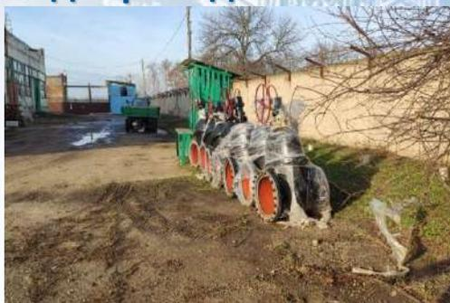
В рамках реализации производственной программы 2021 года специалисты ремонтно-эксплуатационного управления «Ейский групповой водопровод» ГУП КК «Кубаньводкомплекс» выполнили работы по установке на артезианских скважинах нового насосного оборудования. Всего установлено шесть новых погружных насосов ЭЦВ, предназначенных для подъема воды с глубины.
