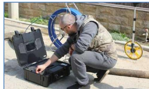
«Диагностическое оборудование передвижной лаборатории позволяет оперативно определять состояние сетей, артезианских скважин и других объектов предприятия, выбирать оптимальное техническое решение для их восстановления, на ранних стадиях устранять дефекты, следовательно – сокращать время ремонтов и сокращать затраты на ремонтные работы, продлевать сроки эксплуатации», - подчеркнул Александр Рыцарев, начальник ИТО ГУП КК «Кубаньводкомплекс».
